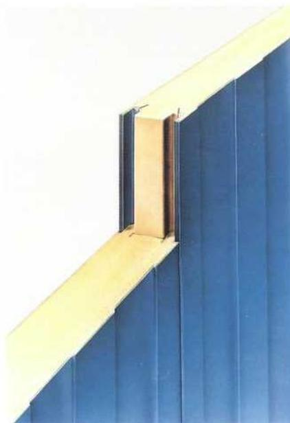
Изготовление включает в себя долговечную точную пригонку, глубокое соединение в шпунт и гребень, четырехкратную надежность уплотнения, оптимальную изолирующую способность благодаря применению жесткого пенополиуретана из **Elastopor H**, отсутствие теплопроводящих мостиков, высокую устойчивость благодаря многослойной конструкции, паронепроницаемым наружным слоям, гигиеничным и не требующим особого ухода.
